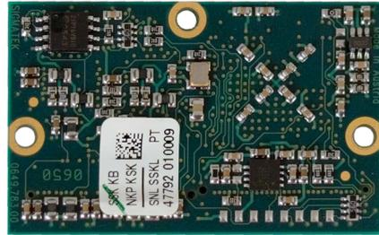
Dieses Manager-Board dient dazu, alle möglichen Peripherie-Geräte auf einfache Weise mit dem VARAN-Bus auszustatten. Durch Einsatz des VEB 031 und einer geringen externen Beschaltung wird das Peripherie-Gerät (über den PCI-Bus) mit zwei VARAN-Manager-Schnittstellen erweitert.
