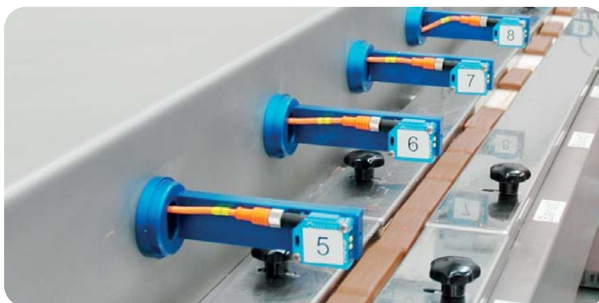
Bild 3: Mit immenser Geschwindigkeit werden die Riegel mithilfe von zehn kurzen Förderbändern und korrespondierender Sensoren auf gleichen Abstand gebracht.
