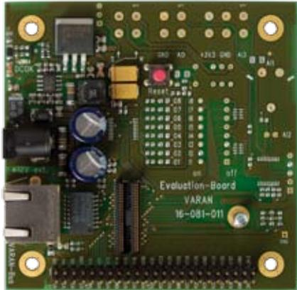
Mit dem VARAN Demo Board VEB 022 soll den VARAN-Usern und den Sensoren-/Aktoren-Herstellern eine einfache Hardware zur Verfügung gestellt werden, um dieses Bussystem schnell und unkompliziert in deren Produkten zu implementieren.
